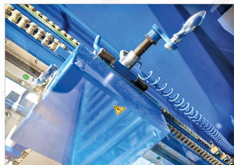
Remplacement de la chaîne sans aucun outillage
