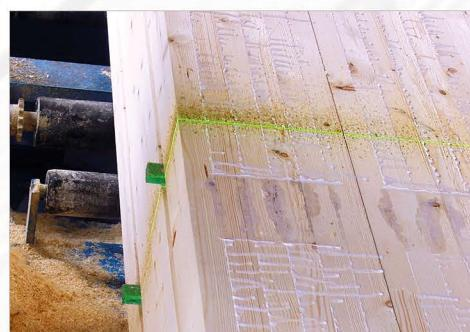
Лазерная проекция резки
