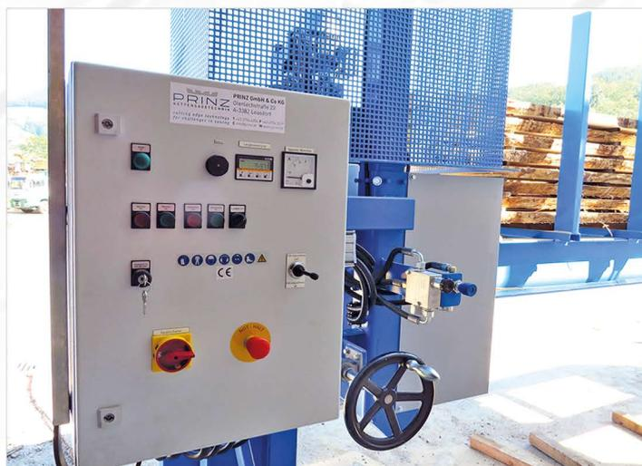
При заказе комплектации MOBILCUT COMFORT+ вы можете дополнительно осуществлять автоматическое позиционирование пильного блока при помощи встроенного измерительного прибора.
