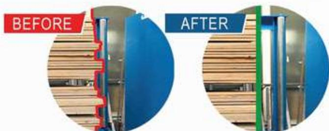
Entwickelt für Effizienz und Präzision ermöglicht die Paketausrichtstation die optimale Ausrichtung Ihrer Schnittholzpakete. Die hydraulisch betriebene Anlage sorgt für eine einfache Ausrichtung der Holzpakete und reduziert oder erspart sogar die Notwendigkeit zusätzlicher Endschnitte.
