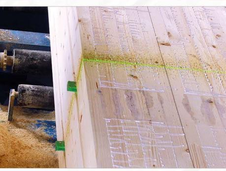
+ Лазерная проекция резки
