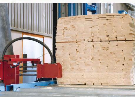
+ Система точного измерения пакета пиломатериала
