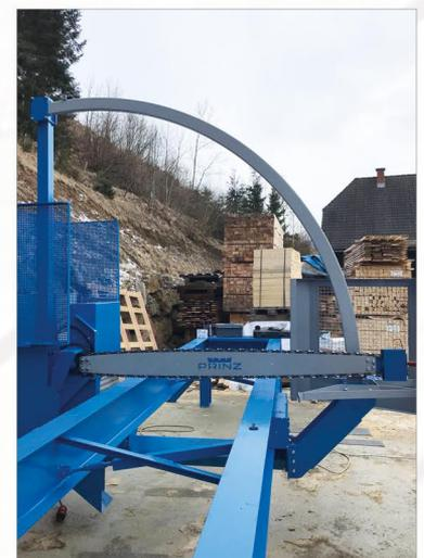
Mit der MOBILCUT TOP LINE besteht die Möglichkeit zusätzlich auch die Positionierung der Sägeeinheit über eine Längenabmessung automatisch vorzunehmen.
