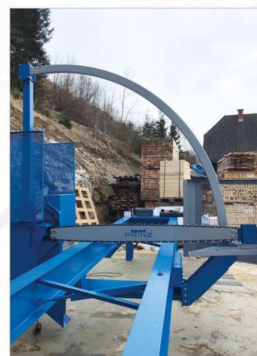
La MOBILCUT TOP LINE offre posizionamento automatico con sistema di misurazione della lunghezza.
