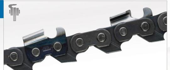
**Eigenschaften:** Durch die kleinere Teilung von 15 mm ergibt sich eine höhere Stabilität im Schnitt. Die Standzeit ist gegenüber der 20 mm Hobelzahnkette länger, aufgrund der höheren Anzahl an Zähnen.
