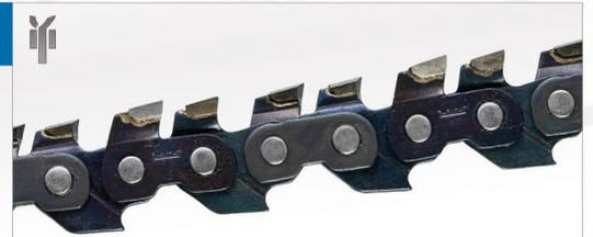
**Eigenschaften:** Das Schneidverhalten ist ähnlich wie bei einer PROCUT Kette, jedoch ist die Standzeit der Hartmetallkette um etwa das 6-fache höher. Diese Kette wird vorwiegend für Hochleistungssägen sowie für Hartholz verwendet.
