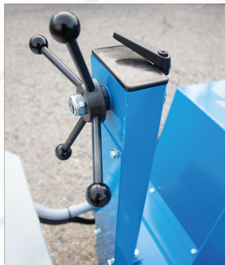
Con meccanismo di spostamento laterale (optionale)
