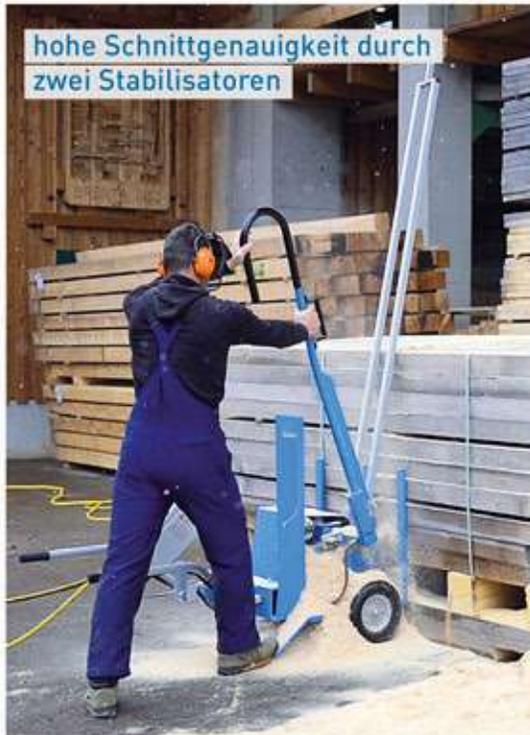
hohe Schnittgenauigkeit durch zwei Stabilisatoren
