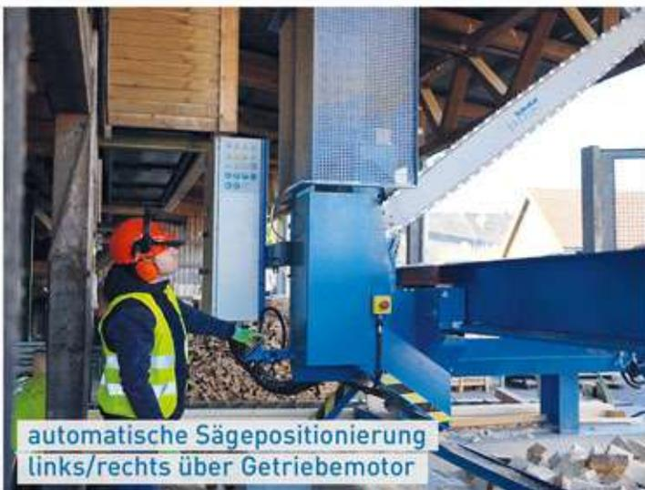
automatische Sägepositionierung links/rechts über Getriebemotor
