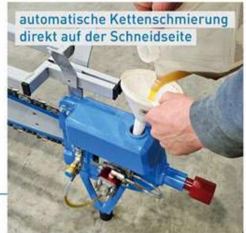
automatische Kettenschmierung direkt auf der Schneidseite
