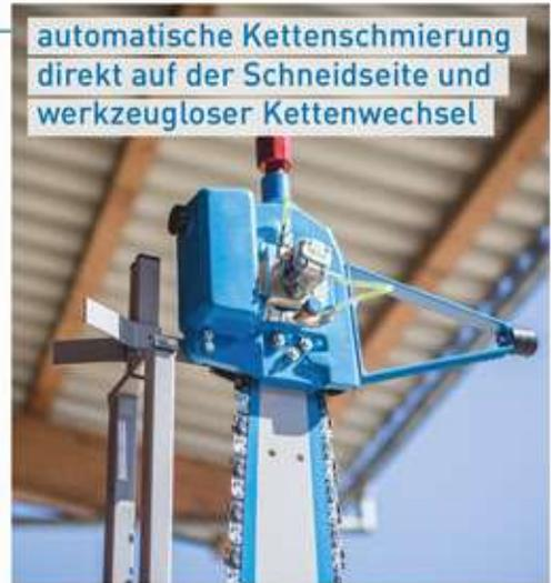
automatische Kettenschmierung direkt auf der Schneidseite und werkzeugloser Kettenwechsel
